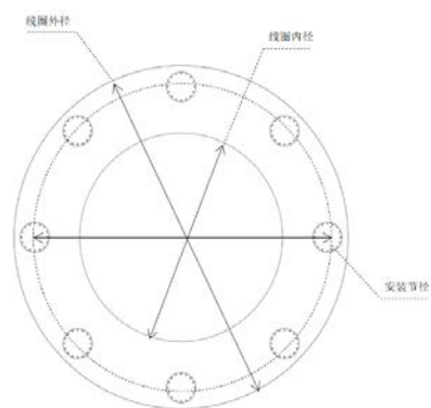
图 1 安装节径示意图
