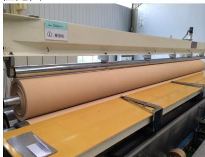
图4 电容心子缠制过程
