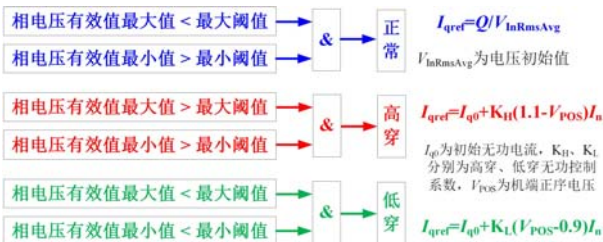
图 6 锡盟风电集中送出系统 SVG 装置原有无功控制策略
