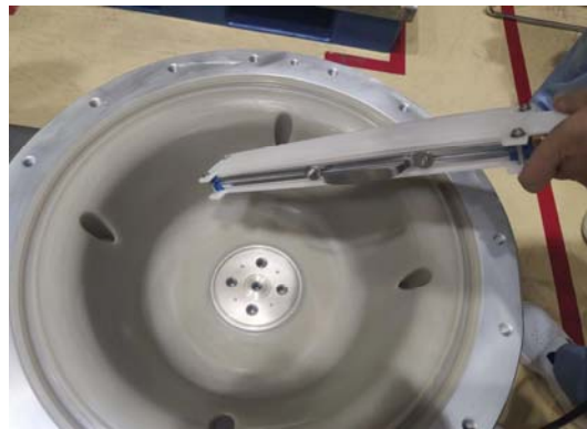
图 3 现场安装无风式除静电装置的实物验证
