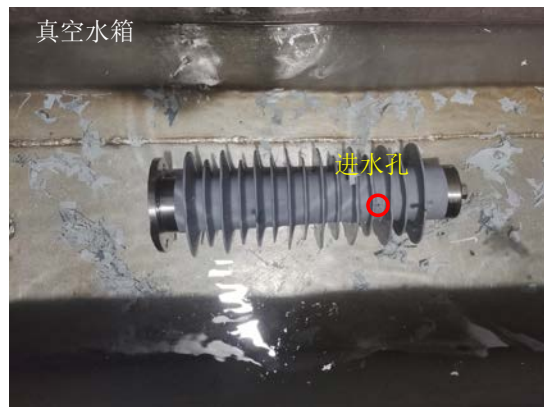
(b) 真空水箱注水
