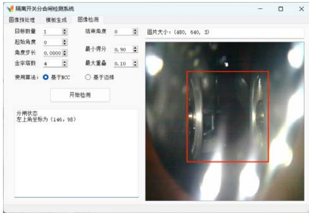
(b) 隔离开关分合闸检测系统模板匹配软件界面
