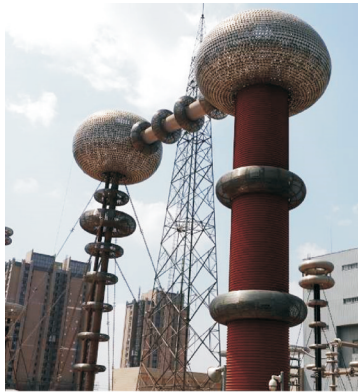
图3 工频试验变压器(右)及分压器(左)
