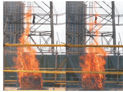
图6 干燥植被燃烧火焰间隙放电图像
