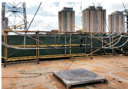
图4 模拟导线与板电极
