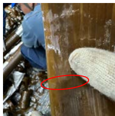
图 7 绝缘纸断裂情况
