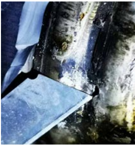
图 12 C 相电缆外护套故障
