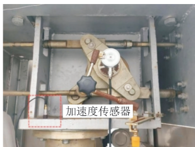
图6 加速度传感器的安装位置
