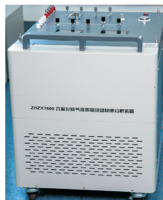
图11 SF 6 气体质量现场一体化检测装置实物图
