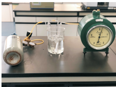
图6 传统矿物油吸收系统示意图
