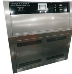
图8 水—热—紫外联合老化试验箱
