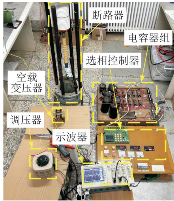
图9 实验测试平台 Fig. 9 Experimental testing platform
