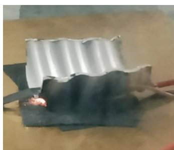
图16 缓冲层放电烧蚀现象
