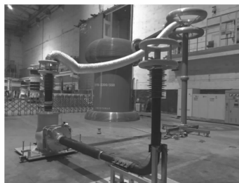
(b) 母线局部放电测量试验布置
