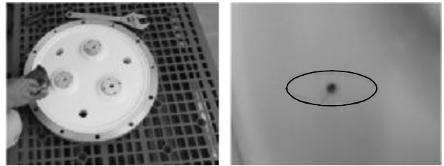
图8 绝缘子内部气泡
