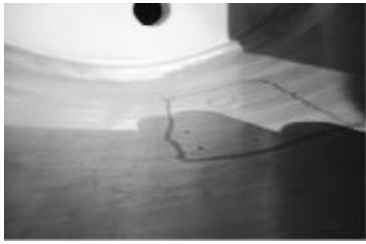
图6 自由金属颗粒缺陷照片
