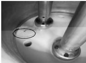
图7 绝缘子上金属异物
