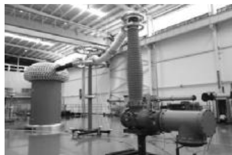
图 1 GIS 模拟试验装置
