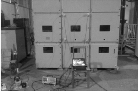
图 5 开关柜局部放电定位试验平台
