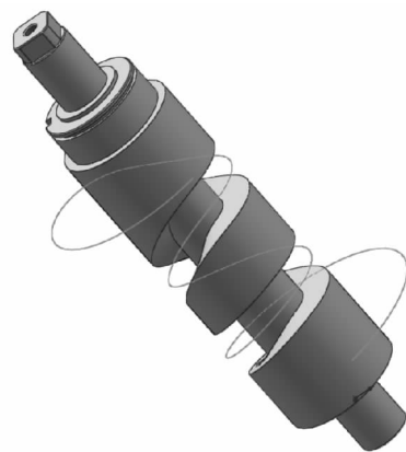
图5 圆柱凸轮设计示意图
