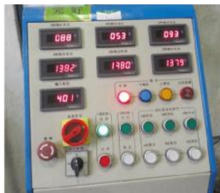
图 3 试验室试验回路电流电压值
