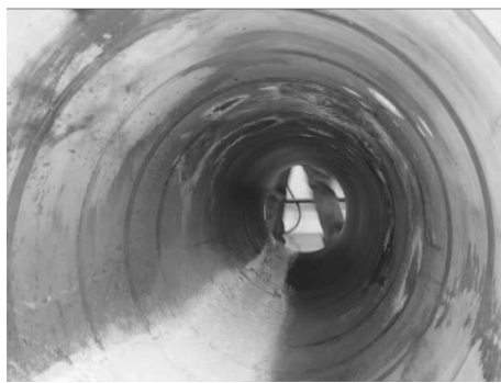
图3 灭弧套管其他部位烧蚀照片
