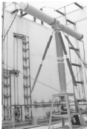
图1 LW15A-550/Y4000-63 产品在西高所做辅助开关照片
