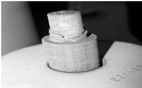
图 11 电阻片穿心杆端头脱离
