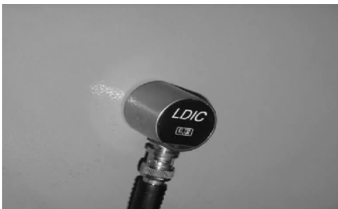
图 2 超声波局放信号传感器安装示意图 Fig. 2 Installation of ultrasonic PD sensor
