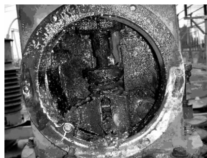
图 1 故障后断路器 B 相手孔
