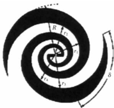
图2 等角螺旋天线结构示意图
