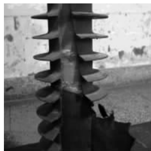
图4 外套与绝缘筒中部粘接不够牢固
