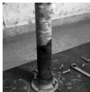
图5 自孔下部绝缘筒表面全部碳化
