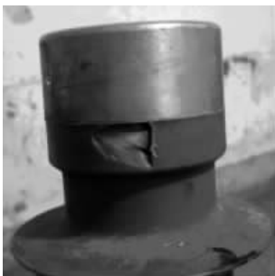
图3 硅橡胶与金属端盖粘接紧密
