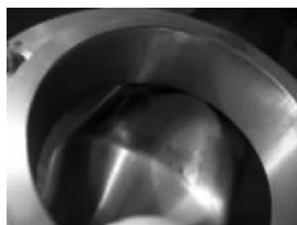
图9 带有划痕的黄铜质支撑圈
