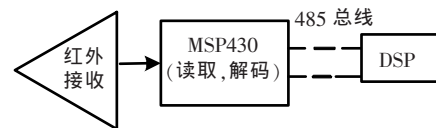
图2 接触式测温装置的接收端
