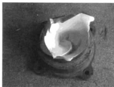
图13 扭转破坏试验断裂截面
