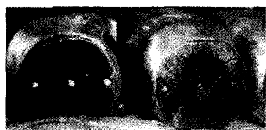
图2 光照变色较重的镀银层(铸铝导体)
