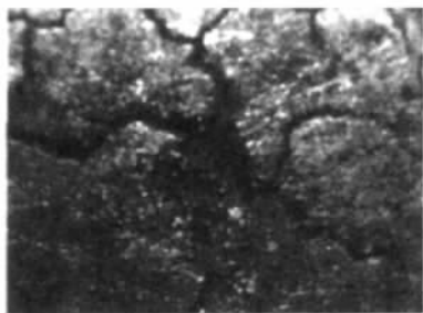
图2 电弧侵蚀后受电弓滑板表面裂纹
