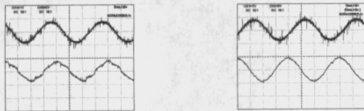
图 8 电网电压和换流器电流波形图 图 9 电网电压和电网电流波形图
