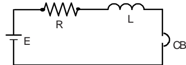
图1 直流系统的简化电路
