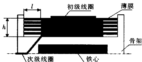
图 2 高压脉冲变压器的结构示意图
