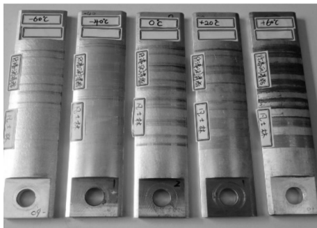
(a) 触头镀银层磨损状态图
