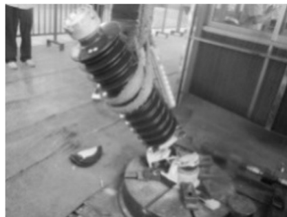
图16 支柱绝缘子抗弯试验状态图
