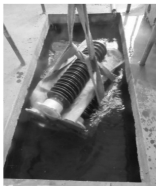
图14 支柱绝缘子热机预应力试验状态图
