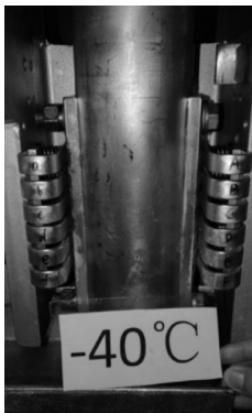
图8 触头机械操作试验状态图
