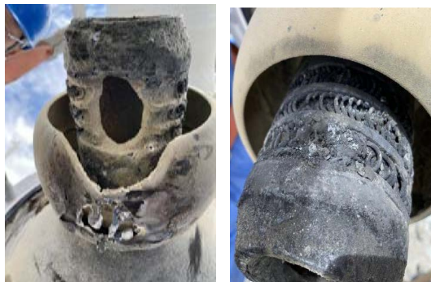
(a) 触头正下方烧熔孔洞 (b) 触头正上方状态
